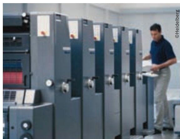
Heidelberg Printmaster 52 drukuje 500 odbitek w 2 minuty.
