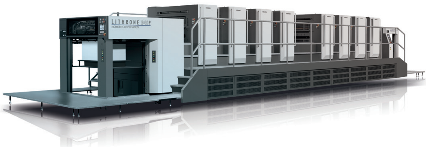
Sześciokolorowa maszyna Lithrone G40 z wieżą lakierującą i systemem suszenia H-UV to sztandarowa konfiguracja Komori do druku opakowań. Urządzenie to drukuje konwencjonalnymi farbami olejowymi i farbami H-UV.
